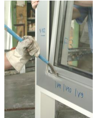
Aufhebelversuche mit Kuhfuß.
