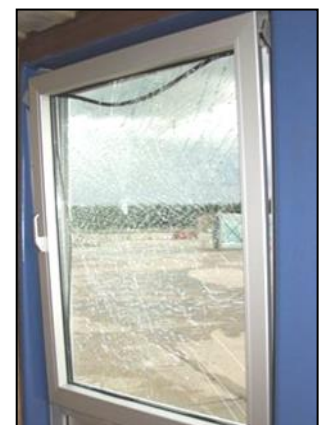
SECURON® widerstand im Sprengtest mit 100kg Sprengstoff erfolgreich dem Druck von 0,87 bar.
