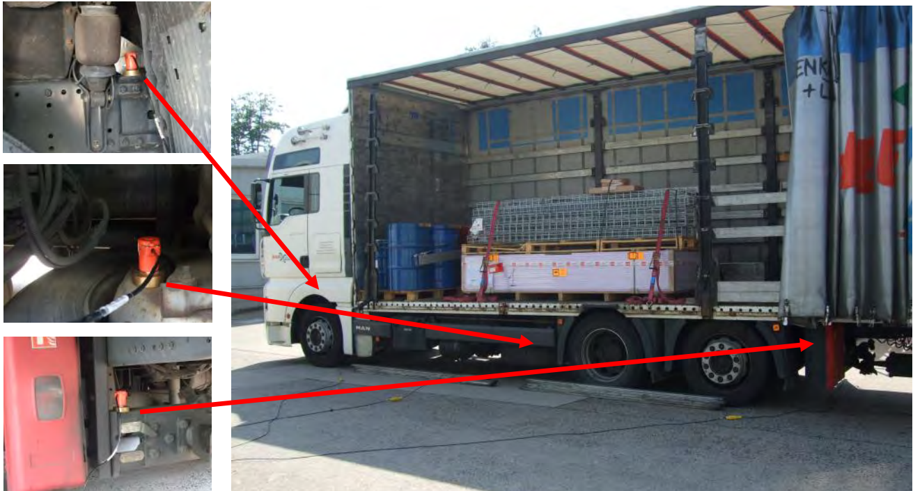
Detektion eines LKW mit 3 Achsen, 3 Sensoren werden in diesem Beispiel für die Detektion eingesetzt.
